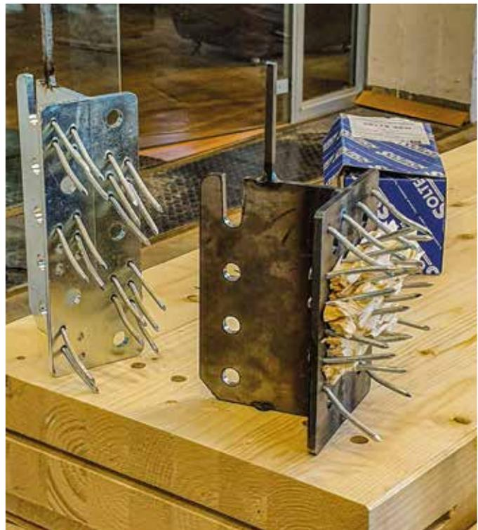
di carichi "end-grain" che "side-grain". Tutti i provini oggetto di test hanno completato positivamente i test: se da un lato le membrature in legno utilizzate hanno evidenziato grandi deformazioni nelle zone di fissaggio (dove è presente la chiodatura e dove sono posizionati gli spinotti), la staffa Steel ha mostrato deformazioni trascurabili e nessuna rottura al termine della prova.
