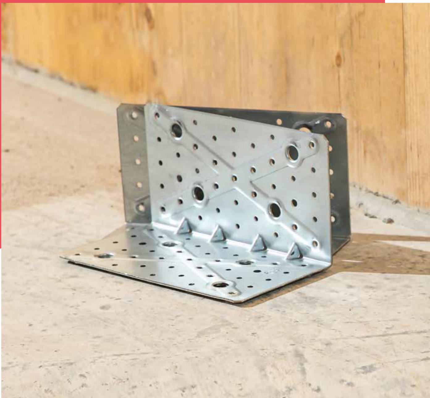
La gamma dei sistemi di fissaggio per carpenteria legno Würth si arricchisce di una nuova e innovativa famiglia di angolari per edifici in legno. Le piastre di ancoraggio Würth DENE B prendono il nome dalla più luminosa stella della costellazione del Cigno, la cui immagine è presente sulla piastra in forma di nervatura a croce che funge da irrigidimento delle flange della piastra.
