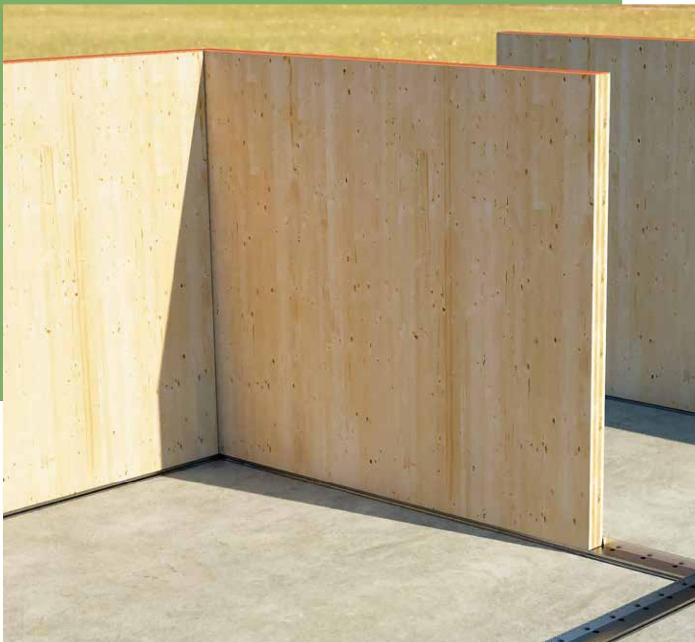
ALU START è il primo profilo marcato CE secondo ETA in grado di assicurare la durabilità di un edificio di legno, ed è allo stesso tempo una "soluzione di sistema" in grado di trasferire alle fondazioni tutte le sollecitazioni (trazione, compressione e taglio) senza l'utilizzo di ulteriori elementi di fissaggio.
