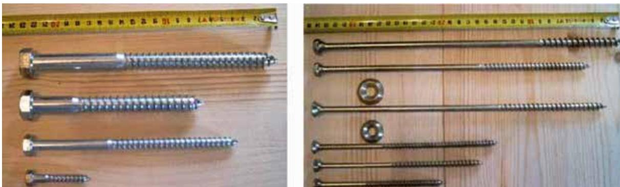
*Fig. 10 - Elementi di fissaggio (esempi): le viti autoforanti consentono la realizzazione del collegamento senza la necessità di preforare; questo ha determinato un passaggio fondamentale nella tecnica delle costruzioni in legno.*
